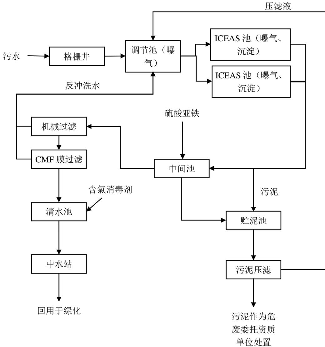
图 2.2.6-3 污水处理工艺流程图
